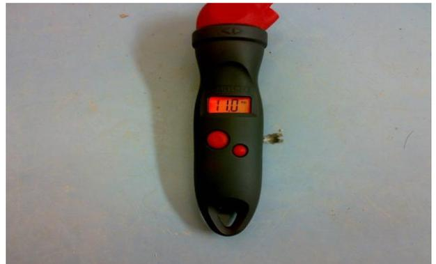
5- إذا كانت القراءة أقل من المطلوب , عندها ينبغي إضافة مزيد من الهواء, أوصل خرطوم بخزان الهواء ومنه إلى بلف الأطار ثم قم بضغط الهواء إلى الإطار, إذا قمت بالخطوات السابقة بشكل صحيح ستسمع صوت الهواء المضغوط وهو يمر عبر الخرطوم إلى الأطار, تأكد من عدم تسرب الهواء حول خرطوم الهواء, استمر بضغط الهواء لمدة 5-10 ثواني, ثم كرر الخطوات 3و4 إلى أن تحصل على القراءة المطلوبة.
