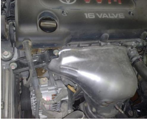
4 - رأس المكينة يوجد بها فتحة صب أو سكب الزيت لتعبئه الزيت بعد افاغه من الكارتير .
