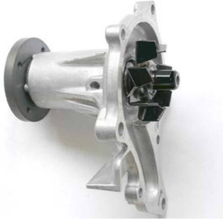
توجد الظلمبة عادة في مقدمة المحرك وتأخذ حركتها من بكرة عمود المرفق (عمود الكرنك) عن طريق سير جلد وتقوم بدفع الماء حول أجزاء المحرك الساخنة فيمر ماء التبريد في الفراغات حول الاسطوانة ثم في الممرات حول الصمامات وقواعد شمعات الإشعال في رأس الاسطوانة.
