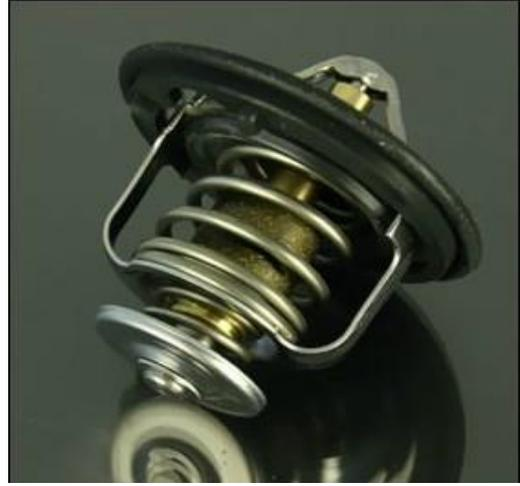
عادة ما يحدث زيادة الضغط داخل دورة التبريد نتيجة زيادة الحرارة .. لذلك كان استخدام ترموستات لتنظيم حركة المياه داخل الدورة.
