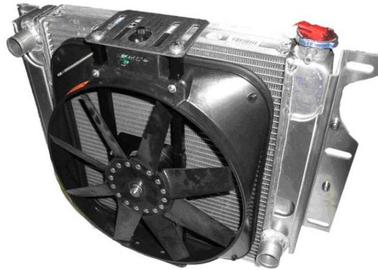
و تعمل المروحة أوتوماتيكيا عند توقف السيارة و ذلك عن طريق (( مفتاح حراري )) – يعمل بفكرة الترموستات – حيث عندما ترتفع درجة الحرارة ، و يحدث تمدد داخل هذا المفتاح مسببا غلق الدائرة الكهربائية وبالتالي تسبب تشغيل المروحة ، و عندما تقل درجة الحرارة ينكمش مسببا فتح الدائرة و توقف المروحة.
