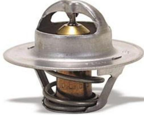
تركيب الترموستات عند مخرج المياه من رأس الاسطوانة إلى الراديتير ، تتحكم في سريان الماء وهي عبارة عن صمام ذو سسته حلزونية مملوءة بسائل يتبخر عند درجة حرارة معينة
