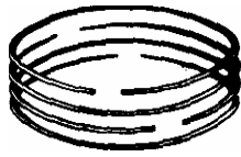
شكل 1 - 11 يوضح شكل شنبر الزيت مصنعة من رقائق من الفولاذ
